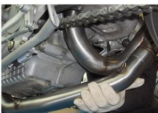
3. Innestare la curva centrale completa " vedi fig. 2 " con il collettore verticale " fig. 1 "
