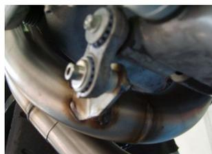
5. Utilizzare la bielletta originale, inserire la vite 6x35 ed il distanziale in dotazione
