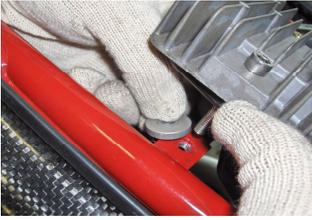
13. Inserire il distanziale in alluminio sotto il regolatore di tensione utilizzando una brugola M6x30 come nella foto.
