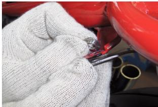
15. Inserire il distanziale sul supporto telaio, e allargare il foro del fianchetto sinistro con punta D.8
