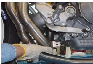
4. Posizionare la staffa della curva centrale con la bielletta completa di silent block e la vite in dotazione.
