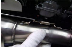
10. Utilizzare brugola M6x30 con silent-block in dotazione, senza serrare.
