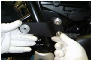
8. Montare la staffa supporto silenziatore utilizzando le viti brugola M8x30 con rondelle d.24x8 e grover d.8 in dotazione, senza serrare.
