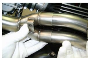
3. Montare tubo centrale 2>1 aiutandosi con un martello di gomma per agevolare un corretto accoppiamento.
