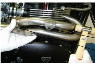
4. Un corretto accoppiamento determina la giusta distanza del fissaggio paracalore
