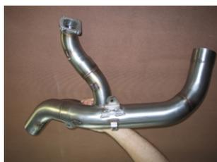
1. Assemblare particolari A, B, e C utilizzando le molle fornite in dotazione con il kit.
