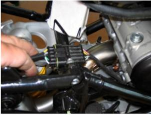
15. 16. Innestare il connettore delle luci e fermare il tutto con una fascetta di plastica
