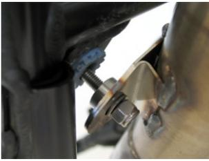
14. Posizionare i distanziali tra supporto scarico e paracalore utilizzando le viti in dotazione M6X35
