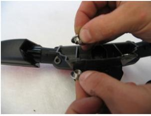
7.8. 9. 10. Per assemblare in modo corretto il gruppo fanale/portatarga posizionare prima la copertura del faro, poi il supporto fanale e in ultimo il supporto targa. Quindi serrare il tutto.
