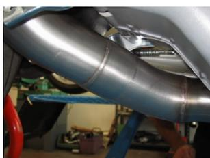
4./5. Innestare collettore orizzontale e posizionare l'attacco testa orizzontale utilizzando le molle in dotazione al kit
